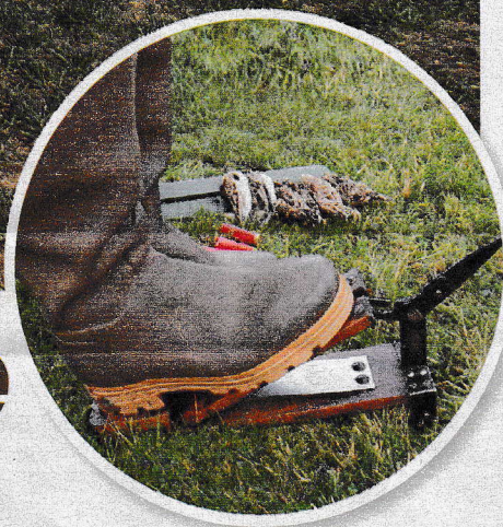
La pédale actionnée par le pied du chasseur fait mouvoir le miroir.
